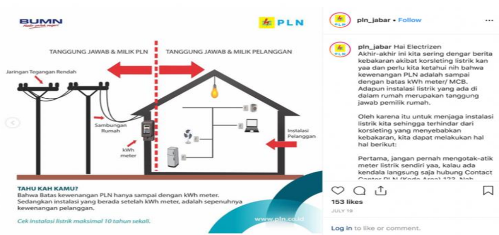
Gambar 2. Infografis Cek Instalasi Listrik
