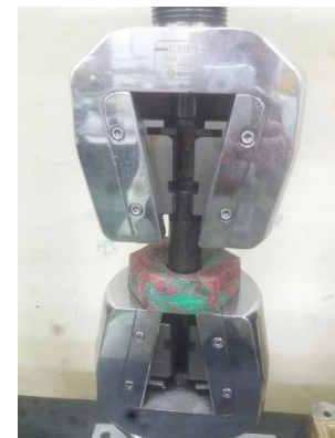
Gambar 10 Proses uji tekan
