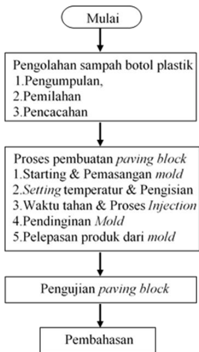
Gambar 6 Flow chart pembuatan paving block
