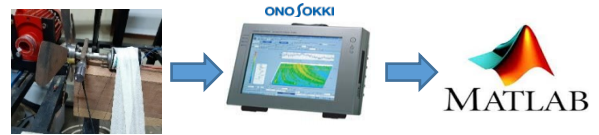
Gambar 6 Set up pengujian pengukuran FRF
