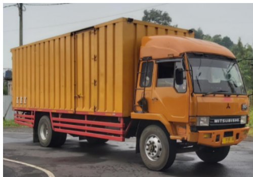
Gambar 1. Truk dengan pengarah angin yang belum maksimal.
