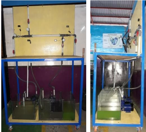
Gambar 4 Alat praktikum penular kalor tipe double pipe yang dibuat
