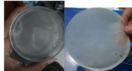
Gambar 5 Membran polimer dari limbah *Styrofoam*
